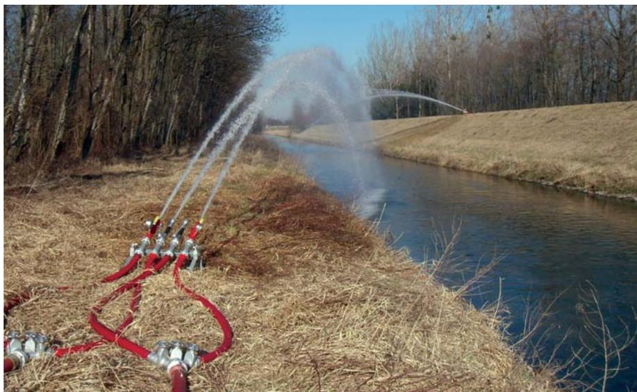
Beidseitig des Binnenkanals im Gebiet Spetzau in Ruggell wurden während 24 Stunden je 1'000 Liter Wasser pro Minute für den Grosspumpversuch entnommen.
