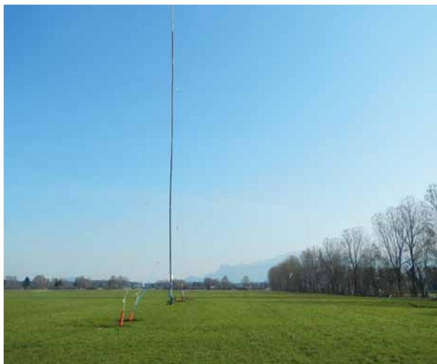
Messmasten der Solargenossenschaft im Ruggeller Riet ausgerüstet mit Windinstrumenten auf 10, 30 und 50 Metern Höhe. Die Anlage wird mit Solarenergie versorgt.
