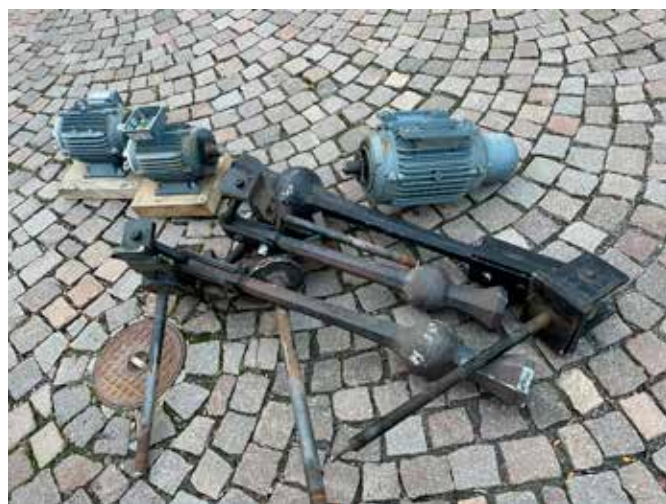
Ausgedient – die alten Klöppel und die alten Antriebsmotoren. Bei den Klöppeln ist sehr gut zu sehen wie «abgebraucht» sie sind.
