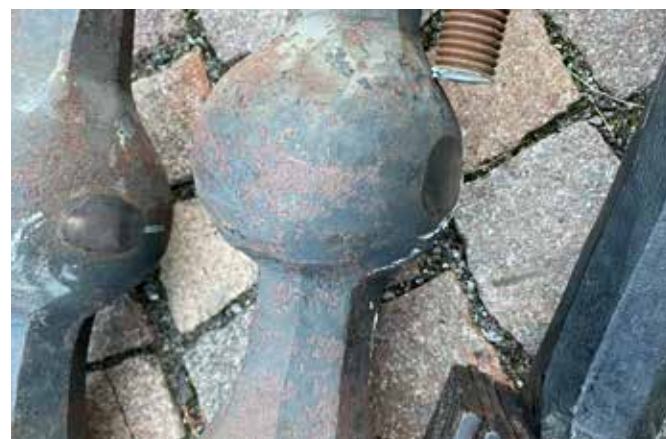
Ausgedient – die alten Klöppel und die alten Antriebsmotoren. Bei den Klöppeln ist sehr gut zu sehen wie «abgebraucht» sie sind.
